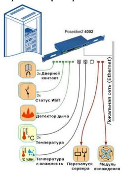
Мониторинг серверных помещений: 6 стоек (12 датчиков) контролируемых Poseidon2 4002
