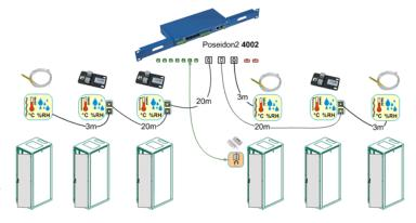
Данный продукт осуществляет отслеживание рабочих параметров Центра Обработки Данных через SNMP (совместимо с Nagios, Cacti, Zabbix, The Dude, Paessler PRTG, OpenNMS, HP OpenView, IBM Tivoli, Axence nVision, Ipswitch WhatsUp, CA NSM, SNMPc и другие)
